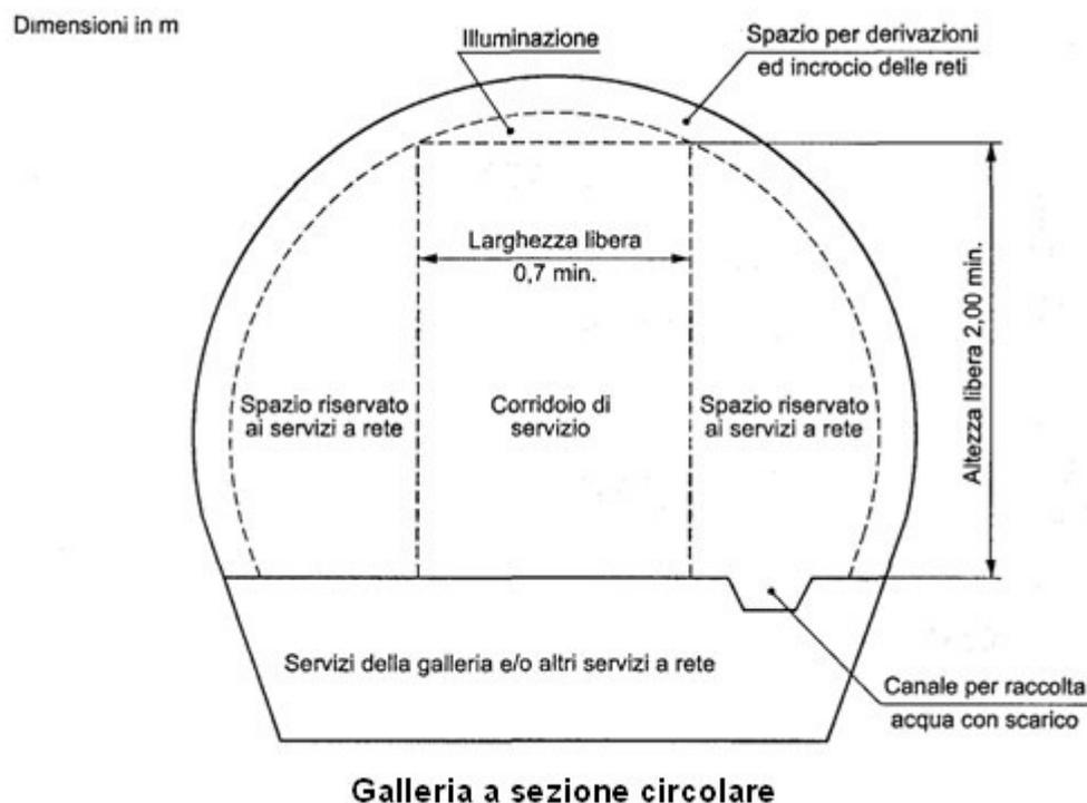
Figura 7.1: Galleria polifunzionale a sezione circolare
